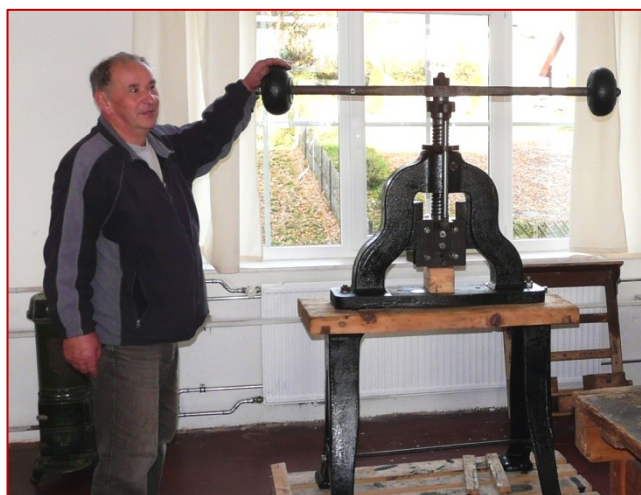
Karl-Heinz Friedrich bei der Anlieferung der großen Handspindel- presse Foto: Michael Schuster
