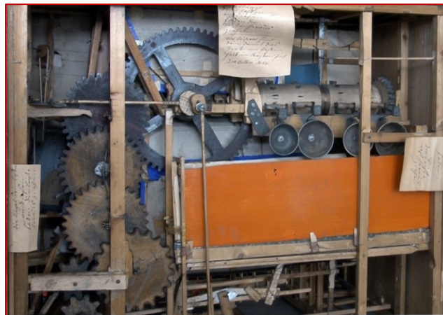
Mechanik von hinten, Umlauf mittels Kurbelantrieb, Umlaufzeit 15 Minuten Foto: Ralf Langer
